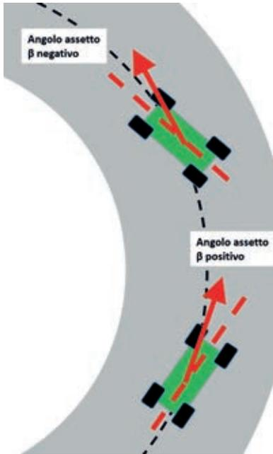
Fig.6\_Andamento dell'angolo di assetto nella manovra di Steering Pad.
